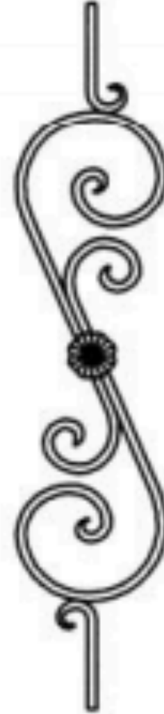
EIW 112 □12-16 / Ø14mm SCROLLS : 12 x 12 / 16 x 8 / Ø14 695 H x 210 W HEB / PL
