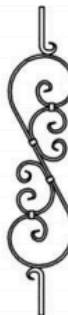
EIW 107 □12-16 / Ø14mm SCROLLS : 16 x 8mm 690 H x 215 W HEB / PL
