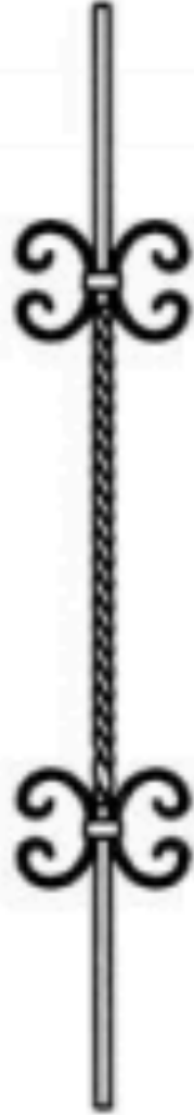
EIW 111 □12-16 / Ø14mm SCROLLS : 13 x 6 / 16 x 8 600 H x 152 W HEB / TBS / PL
