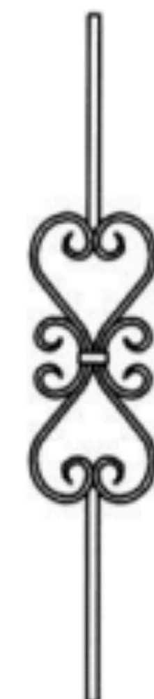
EIW 128 □16mm SCROLLS : 16 x 8mm 420 H x 180 W HEB / PL
